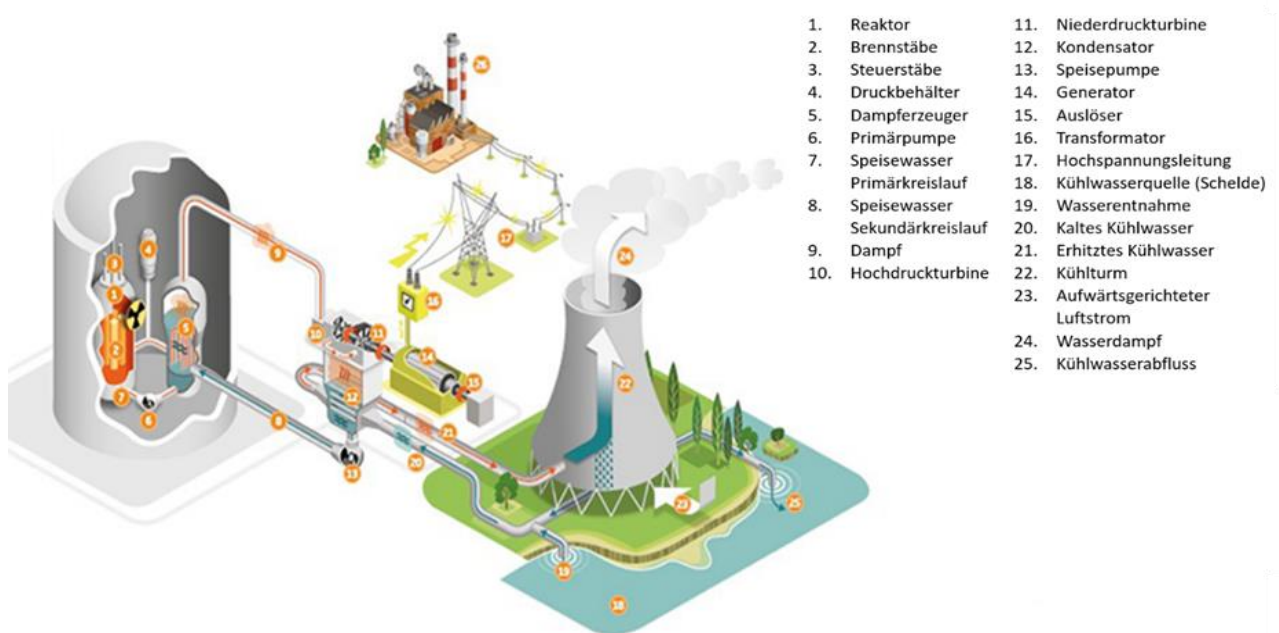
Abbildung 2: Funktionsweise des Kernkraftwerks mit (von links nach rechts) dem Reaktorgebäude, dem Maschinenraum und dem Kühlkreislauf (Quelle: Electrabel AG).
