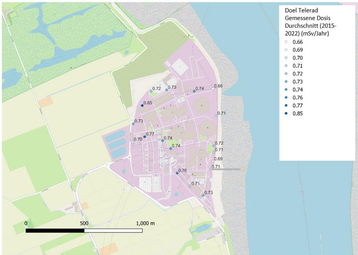
Abbildung 65: Jährliche Dosis in mSv (Durchschnitt über den Zeitraum 2015 bis 2022), gemessen von den von FANK betriebenen TELERAD-Stationen in der Umgebung des Standorts des KKW Doel (Abbildung auf der Grundlage der von FANK erhaltenen 10-Minuten-Daten).
